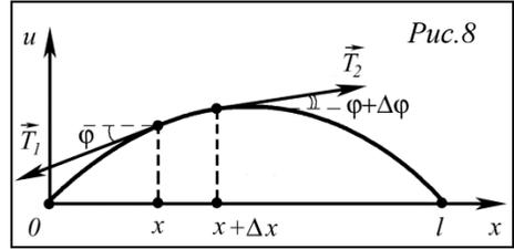
Равнодействующая сил  $\vec{T}_1$  и  $\vec{T}_2$ , действующих на участок  $\Delta m$ , сообщает ему ускорение  $\frac{\partial^2 u}{\partial t^2}$ . Тогда из второго закона Ньютона:
