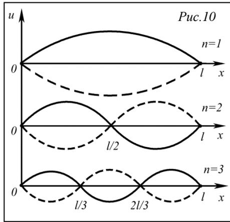
Наименьшая собственная частота  $\omega_1 = \frac{\pi}{l} \sqrt{\frac{T}{\rho}}$  называется *частотой основного тона*. Кратные частоты  $\omega_n = n\omega_1$  называют *гармониками* или *обертонами*. Для каждой гармоники наибольшая амплитуда колебаний  $A_n = \sqrt{a_n^2 + b_n^2}$  будет определяться её номером  $n$  и начальными условиями (4.2.3), так как  $a_n$  и  $b_n$ , в свою очередь, определяются начальной фор-
