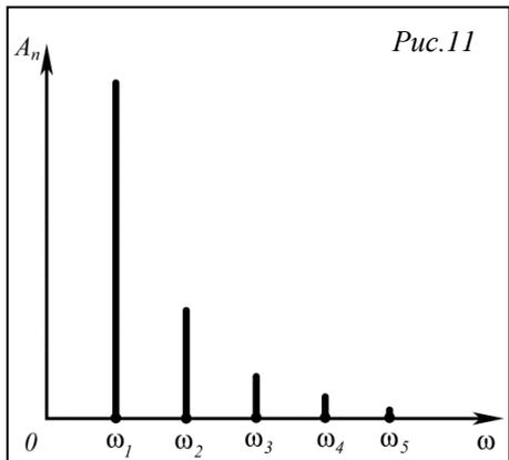
мой струны и начальной скоростью её точек. На рис.11 показан характерный спектр колебаний струны.
